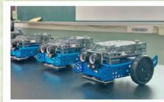
▲透過資訊課程推動AI循跡機器人，讓學生組裝機件組合及電路拼裝測試。
